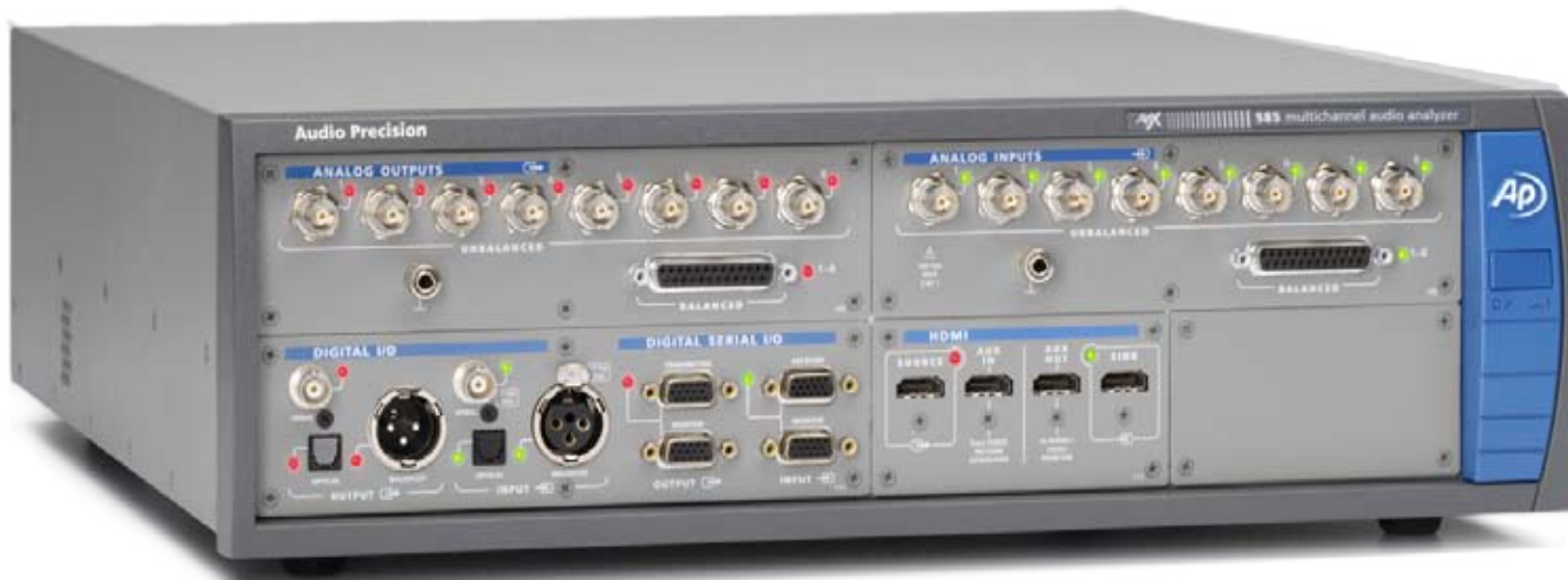
APx585 z opcjami cyfrowego szeregowego wejścia/wyjścia oraz HDMI
